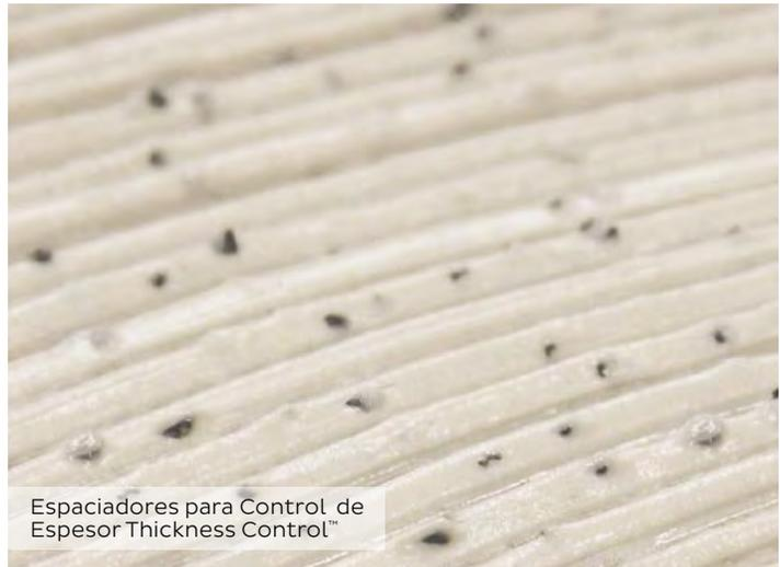
Espaciadores para Control de Espesor Thickness Control<sup>™</sup>
