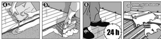
Couper un angle de la poche aluminisée et verser la colle **WOOD H910 SILENTSTIK®** le long de la ligne de démarrage des travaux de pose du parquet.
