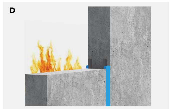
Dubbelzijdige voeg met Bostik FP 402 Fireseal Silicone in combinatie met Bostik rugvulling.
