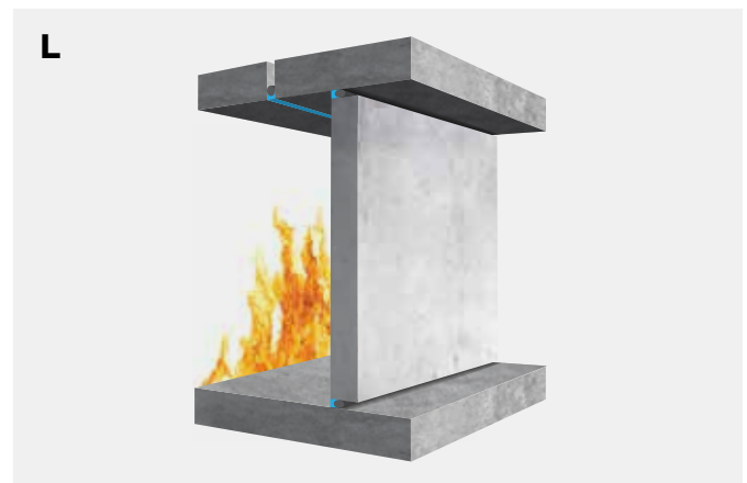
Enkelvoudige voeg richting brand met Bostik FP 402 Fireseal Silicone in combinatie met Bostik rugvulling.
