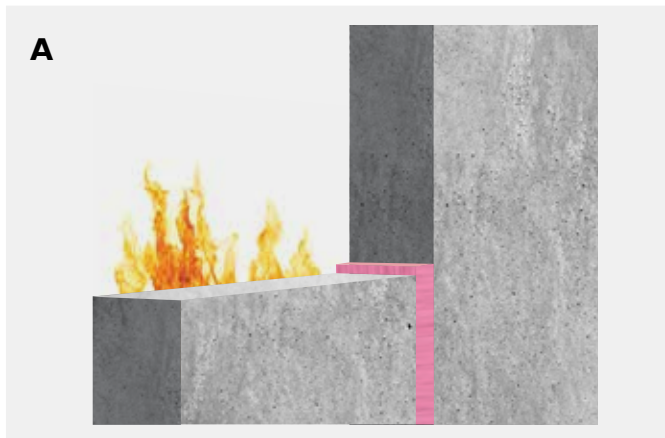
A Voeg volledig gevuld met Bostik FP 404 Fire Retardant PU Foam .
