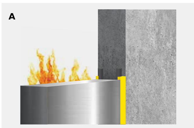
Dubbelzijdige voeg met Bostik FP 403 Fireseal Hybrid in combinatie met Bostik rugvulling.
