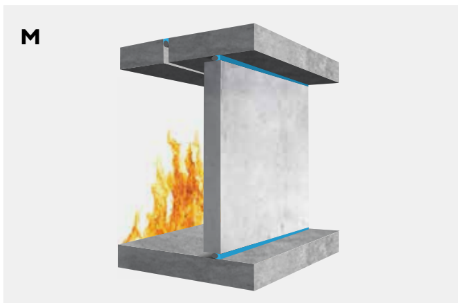
Enkelzijdige voeg met Bostik FP 402 Fireseal Silicone in combinatie met Bostik rugvulling.
