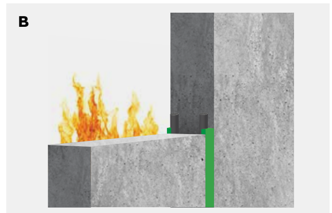
Dubbelzijdige voeg met Bostik FP 401 Fireseal Acrylic in combinatie met Bostik rugvulling.
