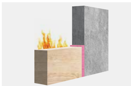
Toepassingsvoorbeeld 1: Afdichting tussen steen en hout.
