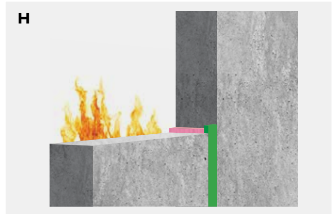
Enkelzijdige voeg met Bostik FP 401 Fireseal Acrylic in combinatie met Bostik FP 404 Fire Retardant PU Foam .
