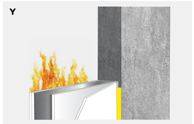
Enkelzijdige voeg in dubbel gipsplaat met Bostik FP 403 Fireseal Hybrid .
