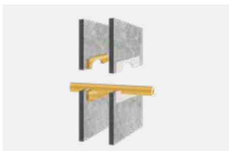
Toepassingsvoorbeeld 2: Leidingafdichting in gips-, metsel- of betonwanden
