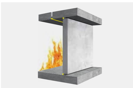
Toepassingsvoorbeeld 1: Afdichting tussen steen, wand/vloer en wand/plafond.
