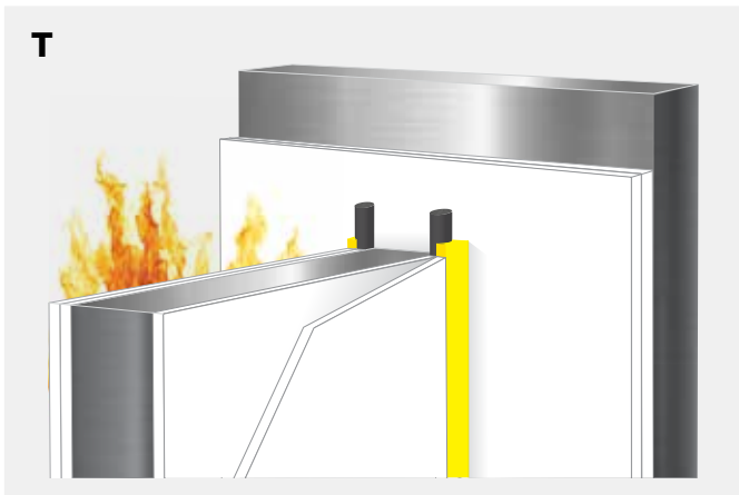
Dubbelzijdige voeg in dubbele gipsplaat met Bostik FP 403 Fireseal Hybrid in combinatie met Bostik rugvulling.
