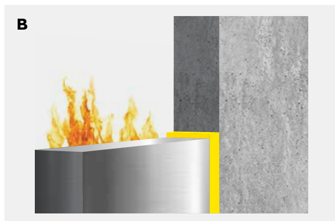
Voeg volledig gevuld met Bostik FP 403 Fireseal Hybrid .
