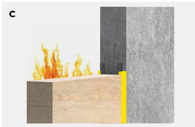
Dubbelzijdige voeg met Bostik FP 403 Fireseal Hybrid in combinatie met Bostik rugvulling.
