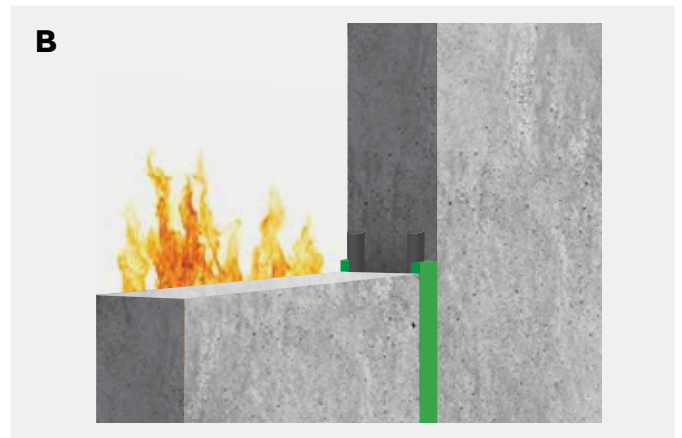
B Dubbelzijdige voeg met Bostik FP 401 Fireseal Acrylic in combinatie met Bostik rugvulling.
