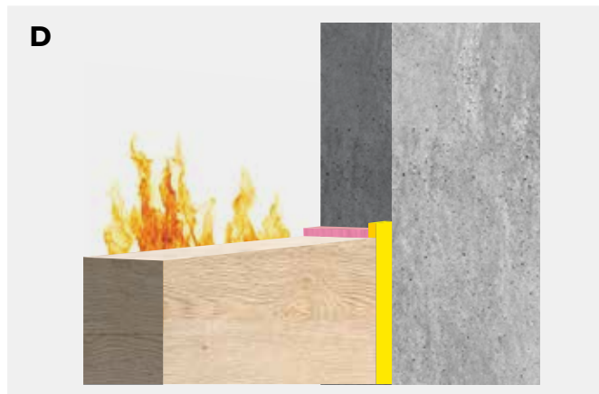
Enkelzijdige voeg met Bostik FP 404 Fire Retardant PU Foam in combinatie met Bostik FP 403 Fireseal Hybrid .
