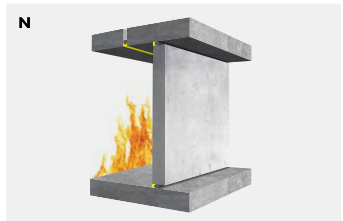
Enkelvoudige voeg met Bostik FP 403 Fireseal Hybrid in combinatie met Bostik rugvulling.
