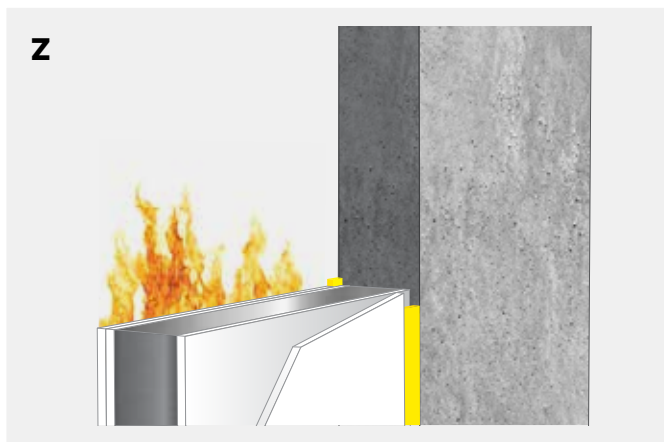
Dubbelzijdige voeg in dubbel gipsplaat met Bostik FP 403 Fireseal Hybrid .
