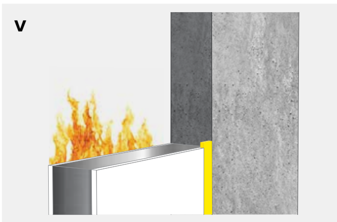
Enkelzijdige voeg met Bostik FP 403 Fireseal Hybrid .
