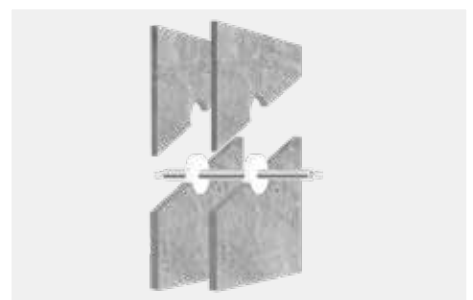
Toepassingsvoorbeeld 2: Kabelafdichting van doorvoeringen in gips-, metsel- of betonwanden.
