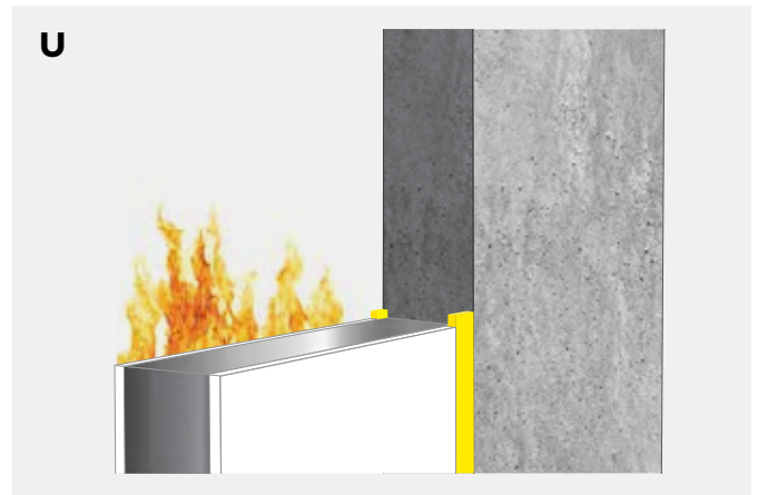
Dubbelzijdige voeg met Bostik FP 403 Fireseal Hybrid .
