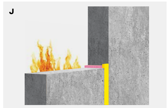
Enkelzijdige voeg met Bostik FP 403 Fireseal Hybrid in combinatie met Bostik FP 404 Fire Retardant PU Foam .
