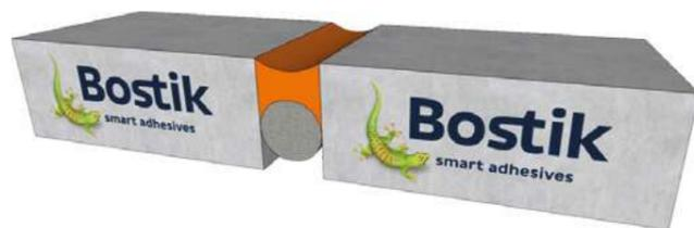
Рис.2 - Влияние сжимающих напряжений на форму шва
