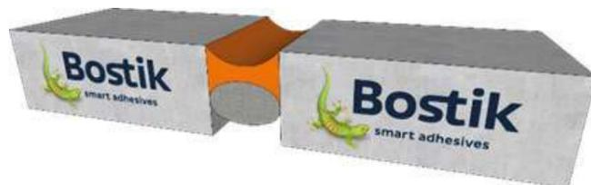
Глубина шва всегда должна быть пропорциональна его ширине. Для ширины шва <10 мм это соотношение должно составлять 1:1 (минимальная ширина и глубина шва = 5 мм). Для швов шириной > 10 мм глубина шва рассчитывается по формуле: Рекомендуется, чтобы максимальная ширина шва не превышала 30 мм.
