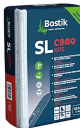
grumeaux. Après un temps de 'maturation' d'env. 1 minute, mélanger à nouveau brièvement. Le mélange peut être utilisé pendant env. 15 à 20 minutes. Ne jamais rajouter d'eau après la préparation du mélange. Étaler le produit à l'aide d'une plâtresse sur le support et régler à l'épaisseur souhaitée. Une 2ième couche peut être appliquée si la 1ère dès que la couche est ouverte à la marche mais pas encore sèche. Si la 1ère couche est sèche, appliquer GRIP A500 MULTI 1:1.
