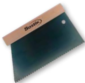
Spatule pour les colles à parquets vinyliques, MS polymère et polyuréthanes destinée à la pose des sous-couches, planchettes et parquets bruts (8 et 10 mm d'épaisseur). Consommation : 600 à 800 g / m<sup>2</sup>..
