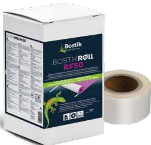
Bande adhésive déposable spécialement destinée à la mise en œuvre des revêtements de sols souples en rénovation. Assure le maintien du revêtement en périphérie de la pièce (BOSTIK ROLL RF 50) ainsi que la jonction entre les lés (BOSTIK ROLL RF 100). Principalement dédié à la pose en semi-libre de revêtements PVC homogènes, hétérogènes et VER en lés.
