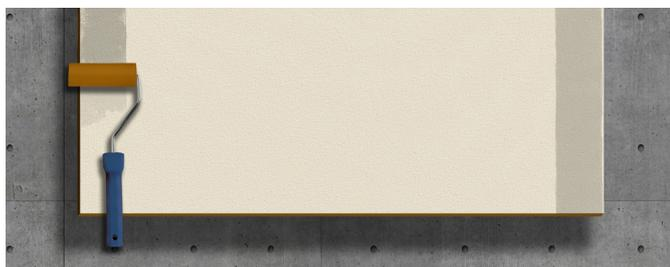
les supports avec le chiffon imbibé. Après l'application, laissez sécher pendant au moins 15 minutes. Changez régulièrement de chiffon. Agitez la boîte fermée de Prep G Plus avant l'utilisation et versez la quantité de primaire dans un bac à peinture propre. Utilisez l'ensemble d'application spécial avec les rouleaux. Appliquez suffisamment de primaire sur la surface de collage en une couche ou un film épais et homogène.
