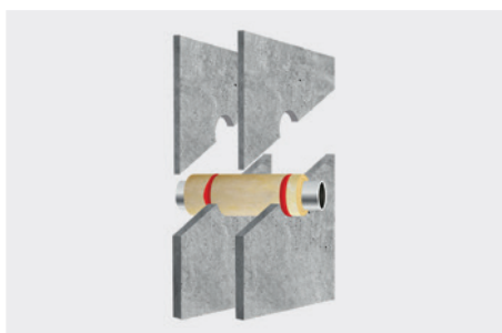
Przykład zastosowania 2: Uszczelnianie rur w przegrodach lekkich i masywnych.
