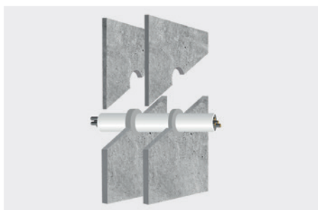
Przykład zastosowania 2: Uszczelnianie rur w przepustach wykonywanych w ścianach lekkich oraz w przegrodach masywnych.
