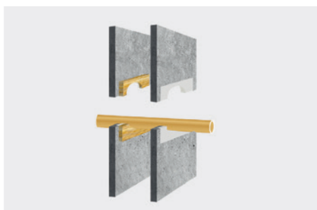
Przykład zastosowania 2: Uszczelnianie rur w ścianie lekkiej, masywnej lub innych typach przegród.
