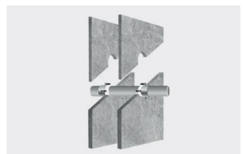
Przykład zastosowania 2: Uszczelnianie rur w ścianach lekkich i masywnych.
