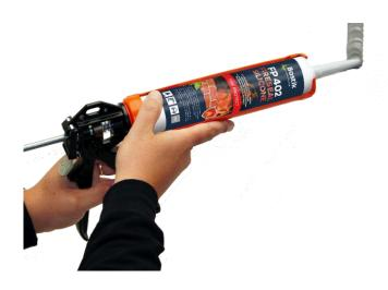
После вскрытия картриджа или упаковок из алюминиевой фольги и их помещения в пистолет насадка обрезается до необходимой ширины выходного отверстия. Ширина выходного отверстия насадки должна соответствовать ширине шва. Насадка обрезается под углом 45°, поскольку во время работы пистолет, как правило, держат именно под таким углом.
