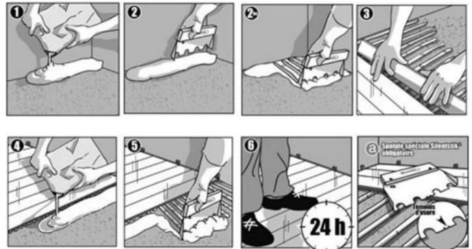
Cortar una esquina de la bolsa aluminizada y verter la cola WOOD H910 SILENTSTIK® a lo largo de la línea de inicio de los trabajos de instalación del parquet.
