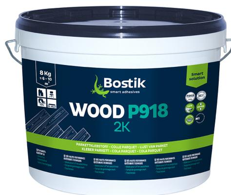
L'humidité relative de l'air sera comprise entre 45 et 65% et ce, AVANT, PENDANT et APRES la pose du parquet. Au-dessus de 2,0% (uniquement pour les supports base ciment) ou en cas de risque de remontée d'humidité, traiter le support avec notre barrière d'étanchéité HYTEC E336 XTREM et coller ensuite le parquet à l'aide d'une colle à parquet appropriée en fonction du type de parquet.
