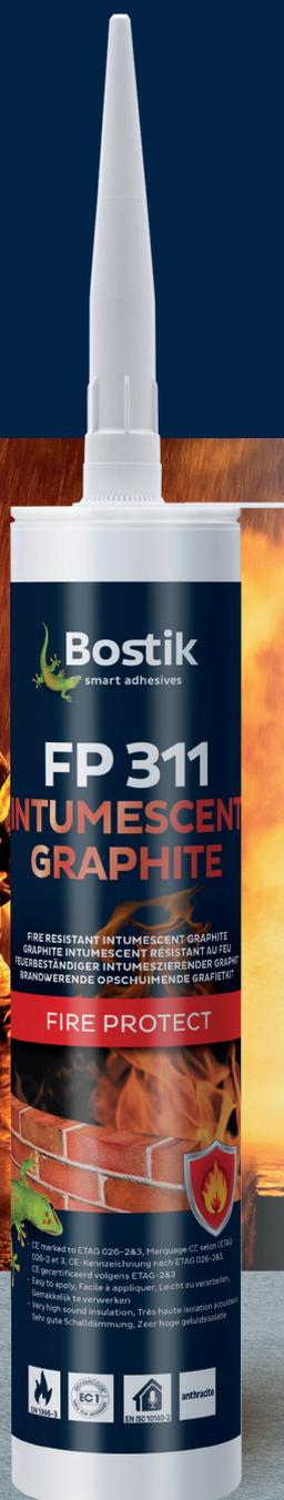
**BOSTIK FP 311 INTUMESCENT GRAPHITE** est une formule hautement élaborée, conçue pour empêcher la propagation du feu, de la fumée et des gaz à travers des ouvertures dans les murs et sols classés résistants au feu. Bostik FP 311 Intumescent Graphite se dilate lorsqu'il est soumis au feu et bouche les ouvertures autour des tuyaux combustibles (par ex. PVC) ou métalliques équipés de matériaux isolants combustibles.
