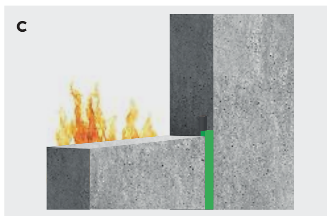
Enkelzijdige voeg met Bostik FP 401 Fireseal Acrylic in combinatie met Bostik rugvulling.
