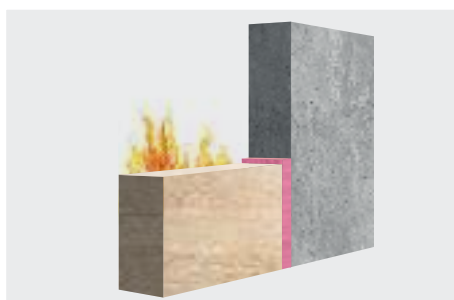
Toepassingsvoorbeeld 1: Afdichting tussen steen en hout.
