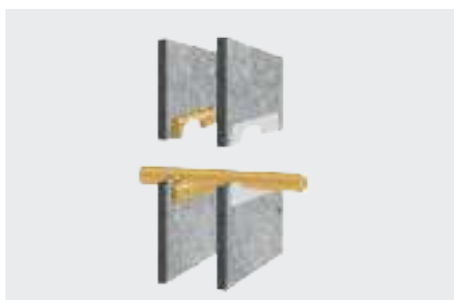
Toepassingsvoorbeeld 2: Leidingafsluiting in gips-, metsel- of betonwanden
