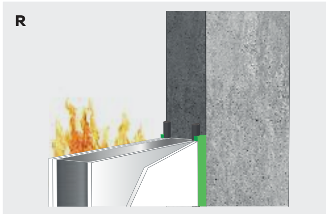
Dubbelzijdige voeg met Bostik FP 401 Fireseal Acrylic in combinatie met Bostik rugvulling.
