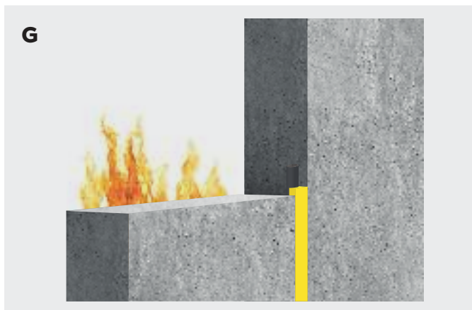
Enkelzijdige voeg met Bostik FP 403 Fireseal Hybrid in combinatie met Bostik rugvulling.
