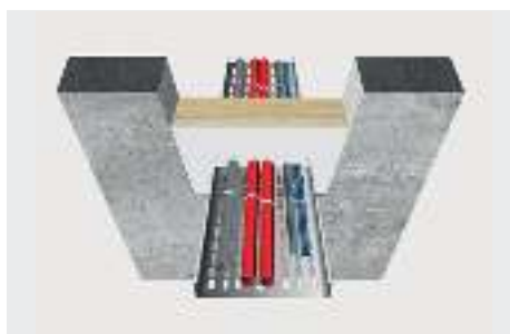
Toepassingsvoorbeeld 1: Het afdichten van kabelgoten in doorbroken wanden.
