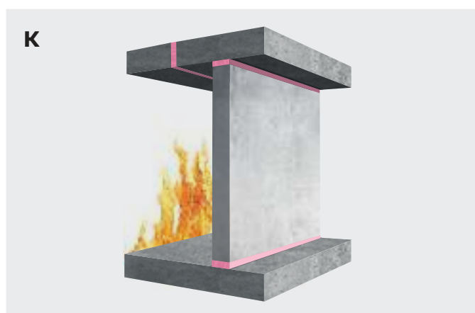
Voeg volledig gevuld met Bostik FP 404 Fire Retardant PU Foam .
