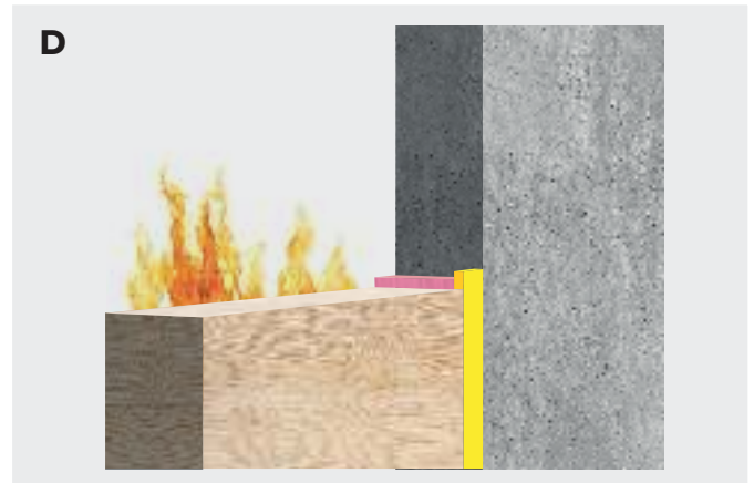
Enkelzijdige voeg met Bostik FP 404 Fire Retardant PU Foam in combinatie met Bostik FP 403 Fireseal Hybrid .
