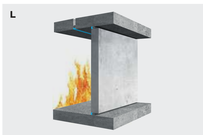
Enkelvoudige voeg richting brand met Bostik FP 402 Fireseal Silicone in combinatie met Bostik rugvulling.
