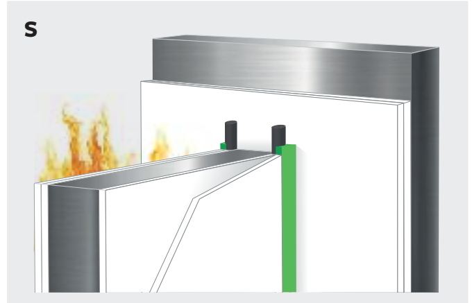
Dubbelzijdige voeg in dubbele gipsplaat met Bostik FP 401 Fireseal Acrylic in combinatie met Bostik rugvulling.
