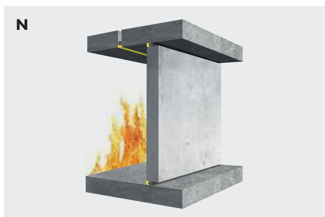
Enkelvoudige voeg met Bostik FP 403 Fireseal Hybrid in combinatie met Bostik rugvulling.
