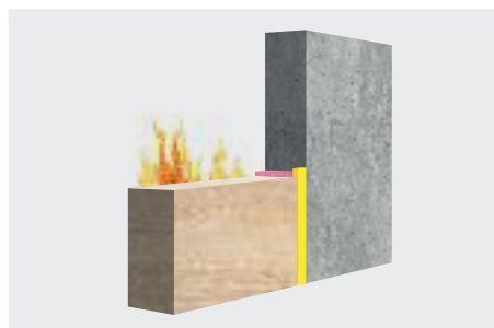
Toepassingsvoorbeeld 2: Afdichting tussen steen en hout in combinatie met FP 403 Fireseal Hybrid.
