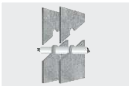
Toepassingsvoorbeeld 2: Leidingafdichting van doorvoeringen in gips-, metsel- of betonwanden.
