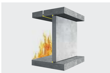
Toepassingsvoorbeeld 1: Afdichting tussen steen, wand/vloer en wand/plafond.
