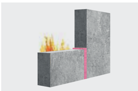
Toepassingsvoorbeeld 1: Afdichting tussen steen
