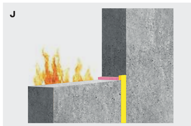
Enkelzijdige voeg met Bostik FP 403 Fireseal Hybrid in combinatie met Bostik FP 404 Fire Retardant PU Foam .
