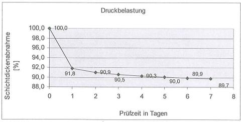
Schichtdickenabnahme = Decrease in layer thickness; Schichtdicke = Layer thickness; Prüftage = Test days
